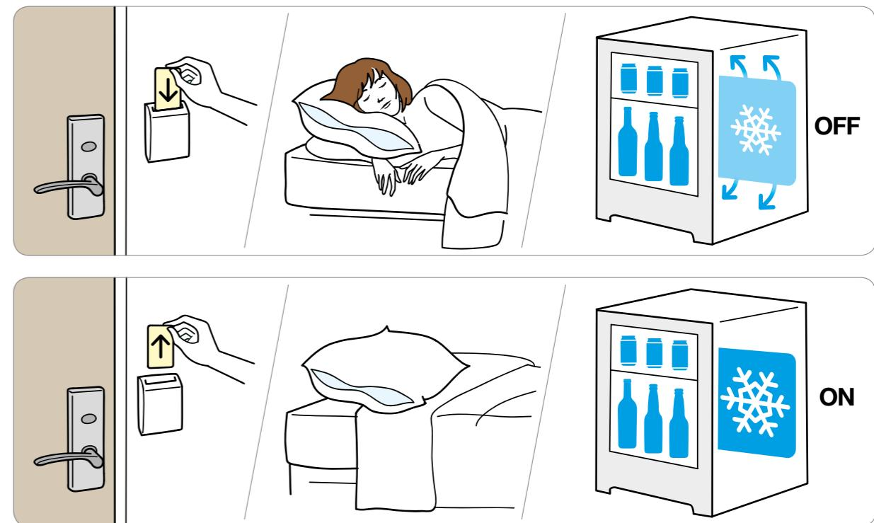
**Il Sistema Smart regola l'accensione e lo spegnimento del compressore in base alla presenza o assenza dell'ospite in camera.** L'utilizzo del Sistema Smart richiede la presenza in camera di un Energy Saver: una tasca porta card per il risparmio energetico.
